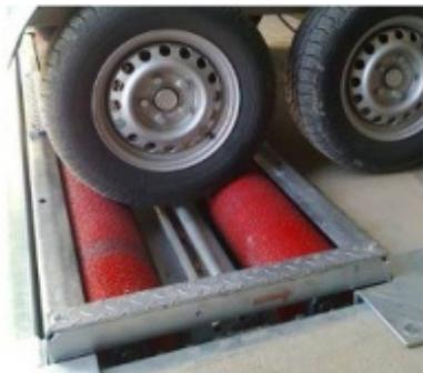
**Пневматическое устройство опускания порога роликового стенда RT60 AutopStenhoj (1260110)**
