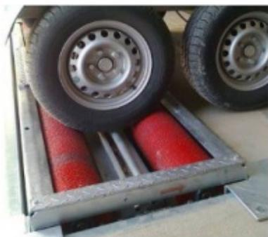
**Пневматическое устройство опускания/
